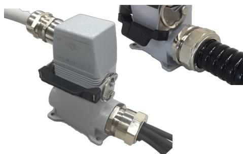
マルチクランプや大口のコンジットに対応した異径ネジ付きグランドは規格寸法を超える場合があります。BOXハウジングのフランジ設置面と干渉する場合がありますので、事前にグランドの外径寸法が許容範囲内であることを下記寸法図表を参考に確認して下さい。
